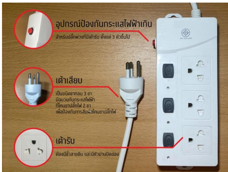
รูปที่ 8 ภาพแสดงลักษณะของปลั๊กพ่วงที่ได้มาตรฐาน มอก. 2432-2555
